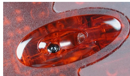
Figura 1: Diodo LED de un ratón óptico
