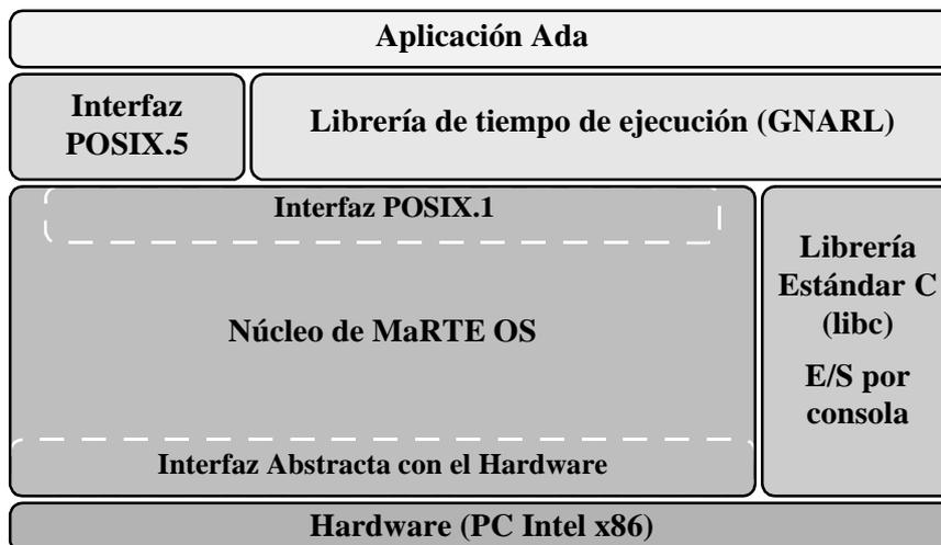
Figura 3.1: Arquitectura de una aplicación Ada ejecutando sobre MaRTE OS
